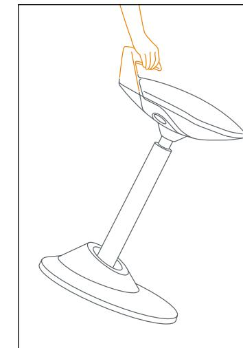
**Um den muv•man zu tragen**, fahren Sie die Höheneinstellung am Sitz nach unten. Zum Tragen verwenden Sie bitte den Sitzgriff. Vermeiden Sie die Berührung der Gasdruckfeder, da diese gefettet ist.
